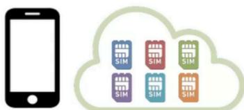
クラウドWi-Fiとは、クラウド上のSIMバンクから最適な通信キャリアを選びインターネットに接続する仕組みのことです。STJレンタルWi-Fiの端末にはControl SIM (ローミングSIM) が1枚内蔵されており、利用場所に応じて自動的に最適なキャリア (docomo/au/SoftBank) を選んで接続します。
